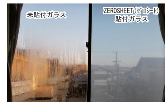
ZEROSHEET（ゼロシート）貼付ガラスは室内側の熱を吸収して室外に逃がしにくくします。その結果、未貼付ガラスよりもZEROSHEET（ゼロシート）貼付ガラスの方がガラス表面温度が高くなり、結露の発生量を軽減する効果が期待できます。
